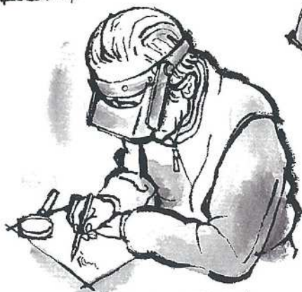
通販で入手した拡大眼鏡。水中メガネのような感じで使う。拡大レンズが2枚ついている。
